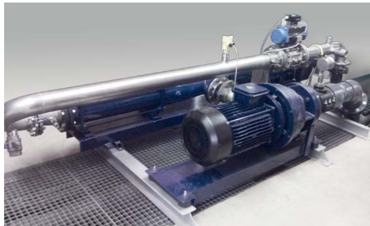
MCC 40 Vorzerkleinerung für Desintegration in Biogasanlage
